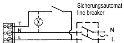
Mit zusätzlichem Betriebs-Ein/Ausschalter für den Hygrostatbetrieb und zweiten Schalter für das Licht im Raum.
