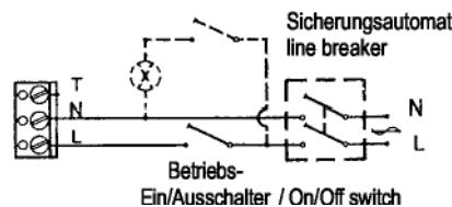
**4.\* Feuchtigkeitsabhängiger Betrieb mit Timer:** Bei Geruchsbelästigung im Bad mit WC arbeitsweise wie bei feuchteabhängigen Betrieb (Schaltung 3) jedoch zusätzlich mit Timer einstellbar von 0,5 bis 25 Min. Im Bedarfsfall zweiter Schalter für das Licht im Raum.
