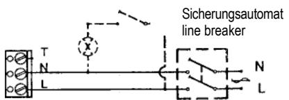
Mit zusätzlichem Betriebs-Ein/Ausschalter für abnormale hohe Luftfeuchtigkeit (größer 80% r.F.) und zweiten Schalter für das Licht im Raum. With additional On/Off-Switch for extreme high humidity (higher 80% r.H.) and second switch for the light.
