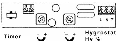
**Einstellung Timer:** Rechtsanschlag - niedrigster Wert (ca 0,5 Min Nachlaufzeit). Linksanschlag - höchster Wert (ca. 25 Min Nachlaufzeit). Die Mittelstellung ist ein guter Wert ca 12 Min.
