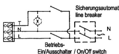
**Einstellung Hygrostat:** Rechtsanschlag - niedrigster Wert (ca. 40 % r.F.). Linksanschlag (ca. 80 % r.F.). Achtung vor zu niedrig eingestellten Werten, da sonst Dauerbetrieb - insbesondere in Monaten mit hoher Luftfeuchtigkeit. Empfohlen wird 75 % r.F. Die Schaltung mit zusätzlichem Betriebs-Ein/Ausschalter für den Hygrostatbetrieb wird empfohlen.
